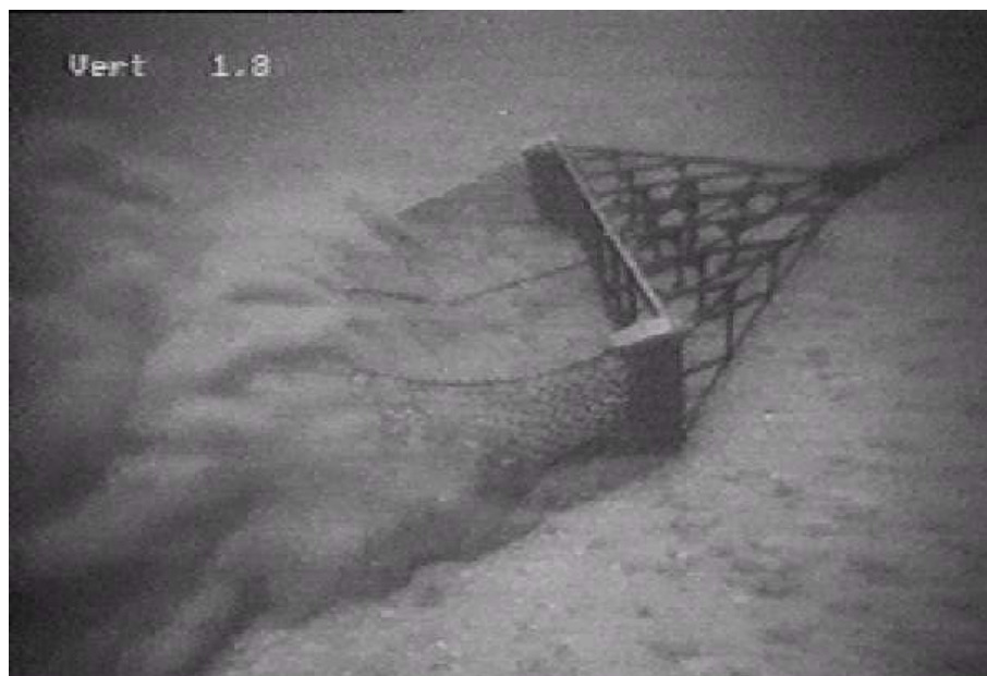
Рис. 115. Подводная фотография процесса драгирования при промысле гребешка, сделанная с помощью «OceanRover» в 1998 г.
